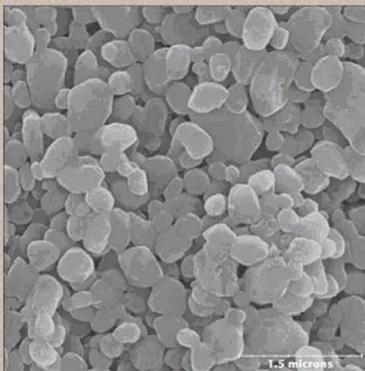
Céramique de cordiérite élaborée à partir du Ghassoul et observée au microscope électronique à balayage
